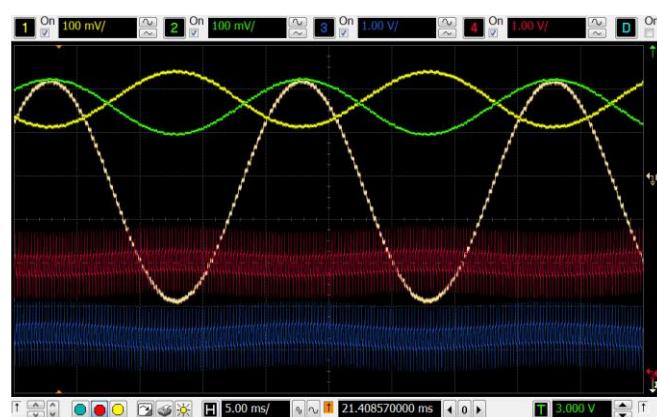
(1-2 通道为差分解调输出，3-4 通道为调制输入，f1=2 通道-1 通道)
